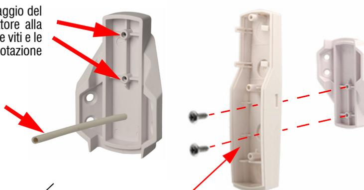
Per garantire il grado IP dichiarato montare la rondella di guarnizione sulla vite di fissaggio come indicato in figura rispettando il verso.
